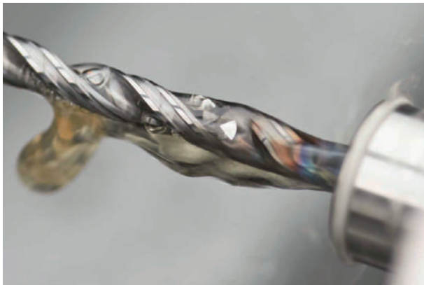
Copeaux produits par une basse fréquence
