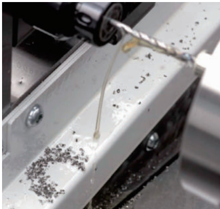
Perçage de trou profond avec un foret à trou d'huile. Les copeaux désintégrés étant expulsés le long des rainures du foret, l'enchevêtrement de copeaux ne représente plus un problème.
