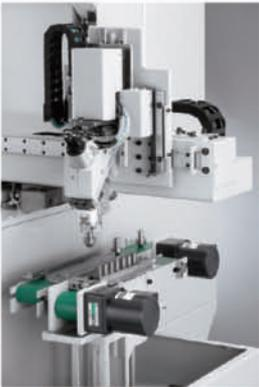
Portique de chargement avec un déplacement grande vitesse de 154 m/min. sur l'axe X.
