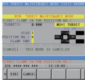
Maintenance de la tourelle Utilisé pour régler le point zéro de la tourelle.
