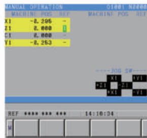
Fonctionnement manuel Affiche le statut du point zéro et la coordonnée de la machine de chaque axe.
