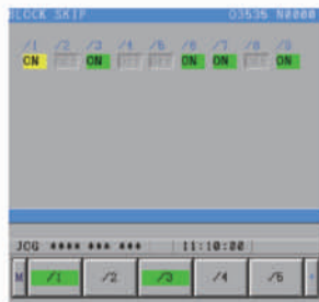
Saut de bloc Utilisé pour régler du saut de bloc 1 au saut de bloc 9.
