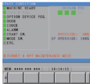
Condition de mise en train Utilisé pour définir les conditions de démarrage pour l'usinage automatique.
