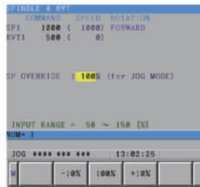
Broche et outils rotatifs Utilisé pour régler la vitesse de rotation de la broche et des outils rotatifs. Utilisé pour régler la correction de la broche.
