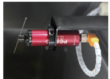
Détecteur de rupture de foret simple à double effet (option) La rupture du foret constatée, la machine s'arrête.
