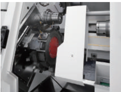
Récupérateur de pièces Évacue les pièces sur le convoyeur.
