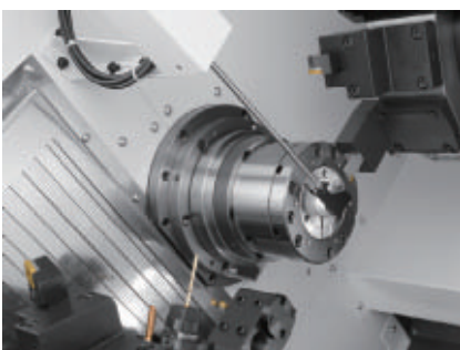
Détecteur de coupe Cette fonction permet de confirmer que la coupe de la pièce est terminée.
